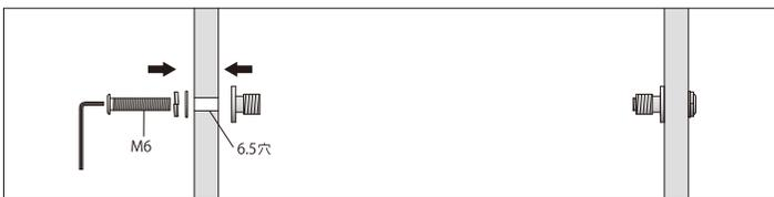
**1** 支柱にφ6.5の穴をあけ、ターミナルの座金を支柱に取付けます。
