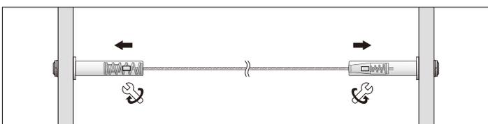
**5** 各ターミナルの5mmの隙間を締め込んで、本締めをします。
